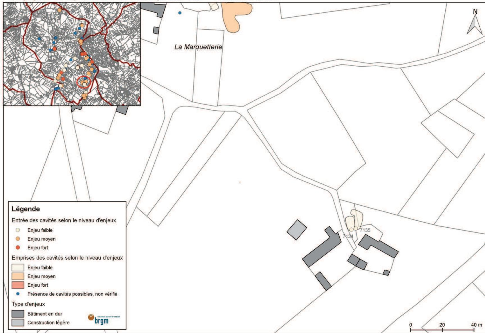
Source : Levés sommaires réalisés par le BRGM à la boussole et au distance-mètre laser (2014). Précision d'ordre métrique à décimétrique. Fond cadastral 2012.
