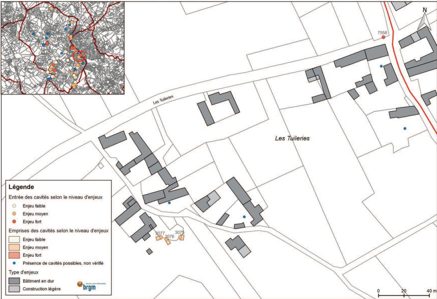
Source : Levés sommaires réalisés par le BRGM à la boussole et au distance-mètre laser (2014). Précision d'ordre métrique à décamétrique. Fond cadastral 2012.
