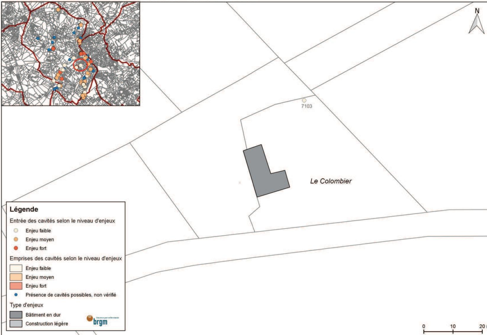
Source : Levés sommaires réalisés par le BRGM à la boussole et au distance-mètre laser (2014). Précision d'ordre métrique à décamétrique. Fond cadastral 2012.
